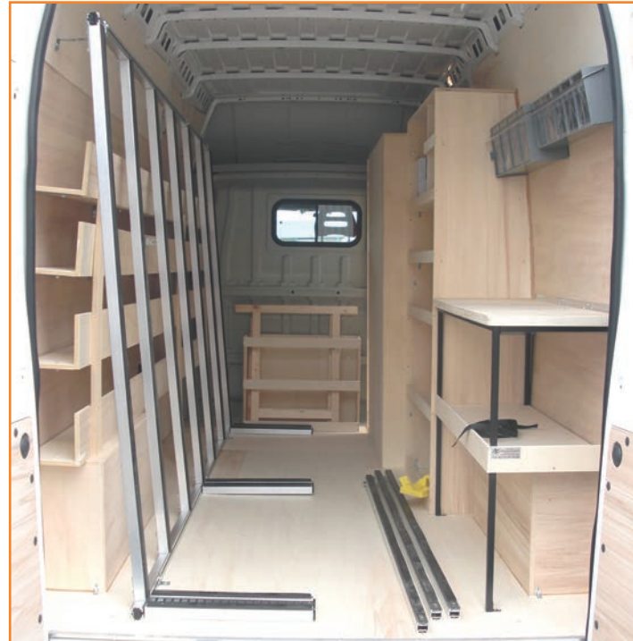
Porte verres intérieur aluminium et établis et meubles spéciaux Porte-verres intérieur, indispensables aux miroitiers et aux menuisiers. En aluminium, ils sont légers et résistants.
