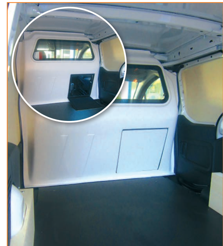
Cloison chauffeur en polyester vitre "sécurité" (trappe amovible sur plusieurs modèles) Cette cloison, vous assure une qualité phonique et thermique de votre habitacle.
