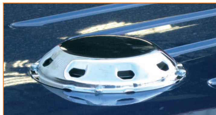
Aérateur de toit à "système dépression"
