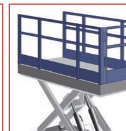
Rambardes fixes hauteur 1,10 m avec lisse intermédiaire et plinthe
