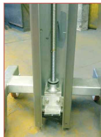
Technologie vis sans fin
