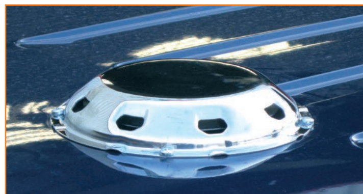
Aérateur de toit à "système dépression"
