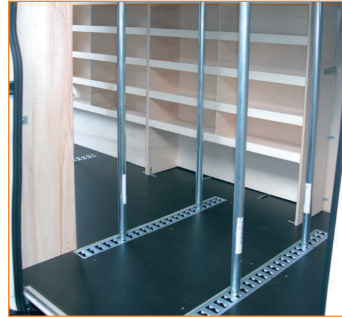
Barres télescopiques rondes en acier zingué Barres télescopique ronde en acier zingué, poids 8,8 kg avec une capacité de blocage de 400 daN (Uniforme). Embout de Ø 19 mm (disponible aussi en Ø 24 mm). Spécialement conçus pour les rails d'arrimage "Universel".
